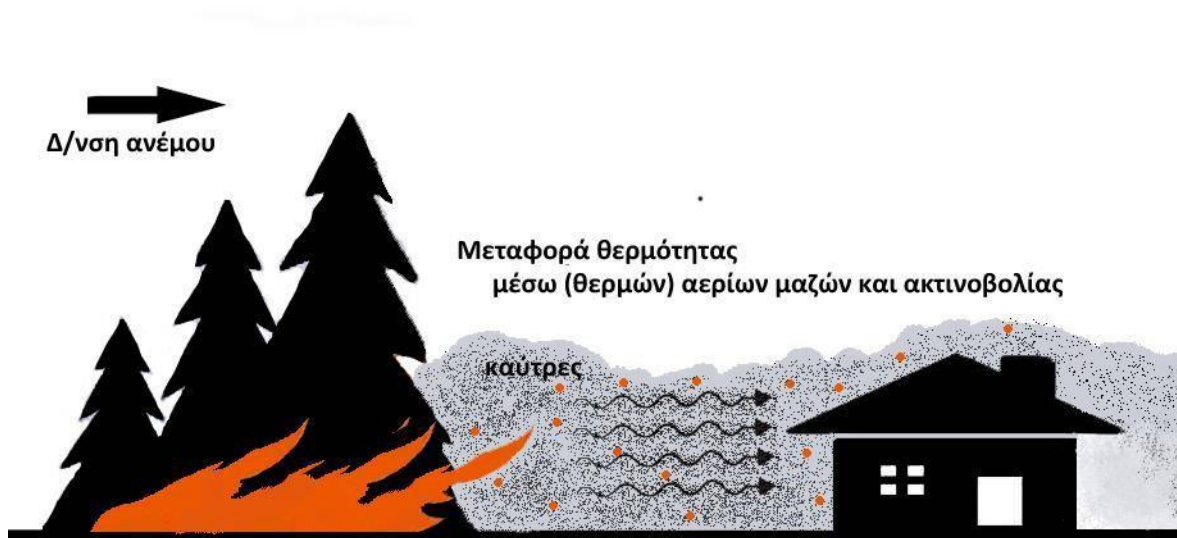
Σχέδιο 4. Τρόποι ροής της θερμότητας σε μια δασική πυρκαγιά, που εξελίσσεται πλησίον κτιρίου και απεικόνιση πιθανού τρόπου μετάδοσης δασικής πυρκαγιάς με μεταφερόμενες καύτρες σε κτίρια παρουσία ισχυρού ανέμου
