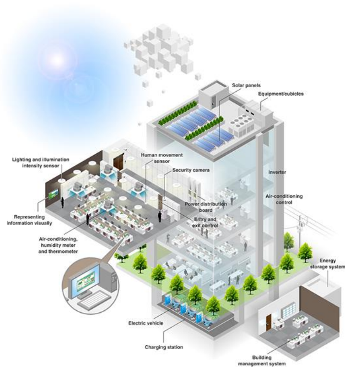
Εικόνα 7.19: Παράδειγμα κτηρίου με θετικό ενεργειακό ισοζύγιο.
